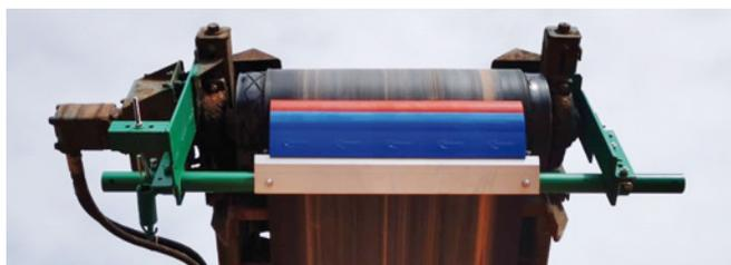
Der Druck auf den Abstreifer wird durch ein Spiralfederspannsystem geregelt, das auch den Verschleiß automatisch kompensiert. Dieses System garantiert eine gleichbleibende Andruckkraft während der gesamten Standzeit der PU-Elemente. Durch den Druckmesser ist die Einstellung und Kontrolle jederzeit sehr einfach durchzuführen.
